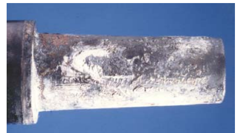
Bild 5: Kern ohne Kühlung für ein Aluminium-Druckguss-Getriebegehäuse. Dieser ist im Betrieb eindeutig zu heiß
